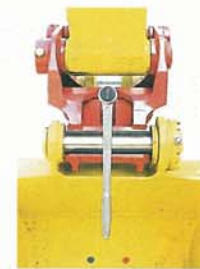
バケットシリンダーを押し出し、交換カブラのリンク側爪にセットし調整ボルトを締める。
