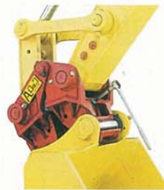
バケットシリンダーを押し出し、交換カブラのリンク側爪にセットし調整ボルトを締める。
