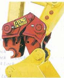
アーム側の爪をアタッチメントのピンにひっかける。
